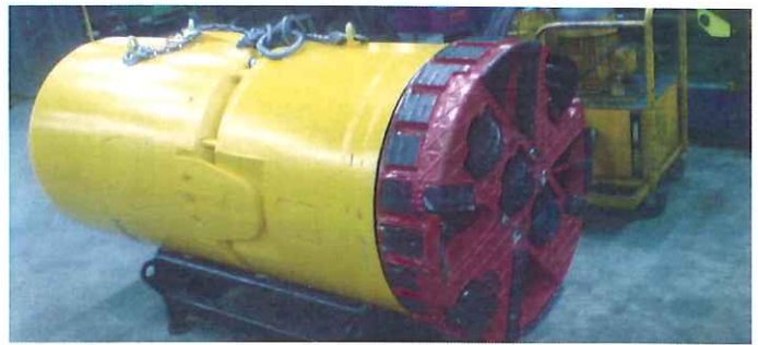
Trousse orientable tête à molettes (type tunnelier)
